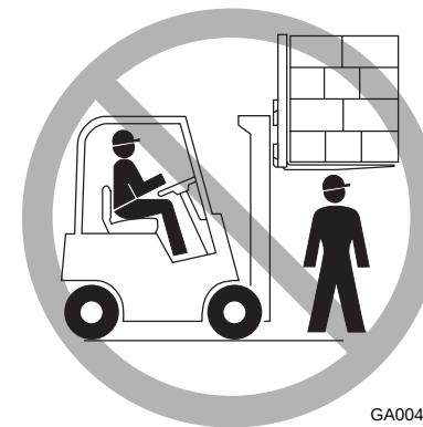
Prohibido permanecer debajo de cargas
