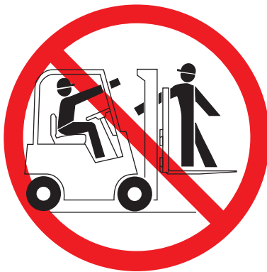
Zakaz przekładania rąk przez maszt
