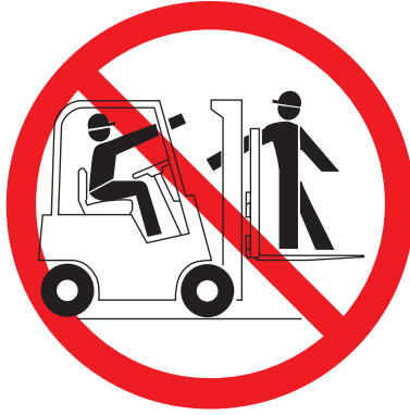
Niet door de hefmast reiken
