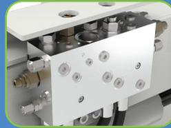
Nuova valvola con sistema di rigenero ad elevata portata idraulica e valvola di massima pressione per le funzioni di apertura e chiusura pinza e traslazione.
