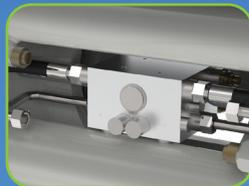
Raccord tournant hydraulique avec cartouche de répartition de débit pour un déplacement synchronisé des fourches
